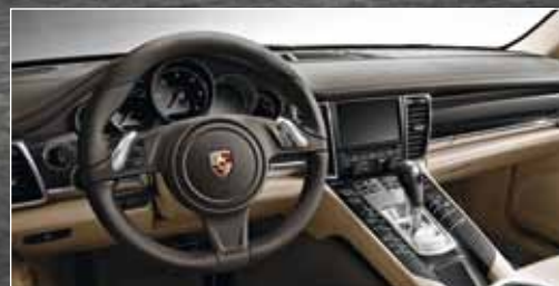
DAS MULTIFUNKTIONSLLENKRAD erlaubt die komfortable Bedienung von Audio-, Telefon- und Navigationsfunktionen sowie Bordcomputer.
